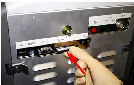
Paveikslėlis F-20 CompactFlash atminties kortelės įdėjimas
