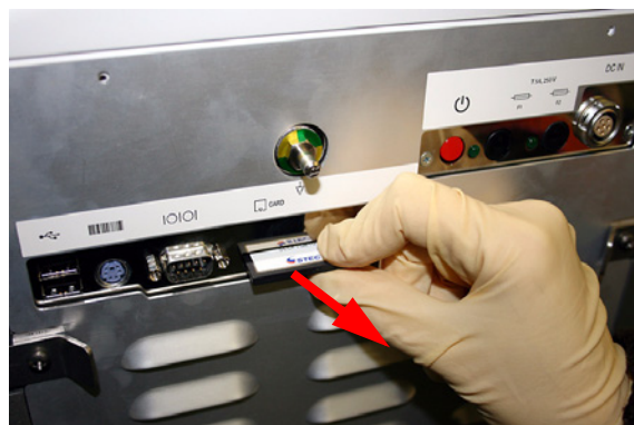
B Išimkite CompactFlash atminties kortelę
