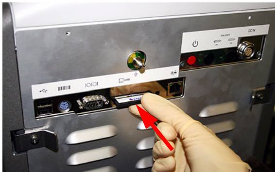
Paveikslėlis F-11 CompactFlash atminties kortelės įdėjimas
