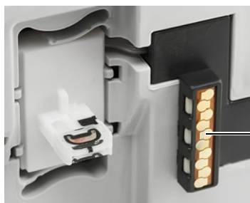
A „Fluid Pack“ pakuotės mėginių jutiklio kontaktai
